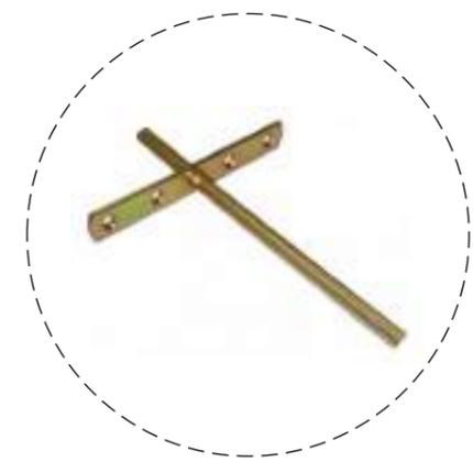
Sistema de fixação das prateleiras com suporte invisível T de 30cm com capacidade de carga de 10kg por suporte, espaçados a cada 20cm;
