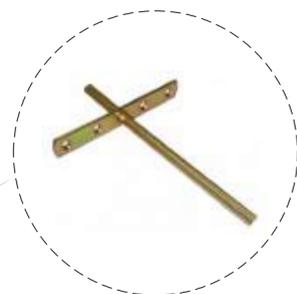
Sistema de fixação das prateleiras com suporte invisível T de 44cm com capacidade de carga de 10kg por suporte, espaçados a cada 20cm;
